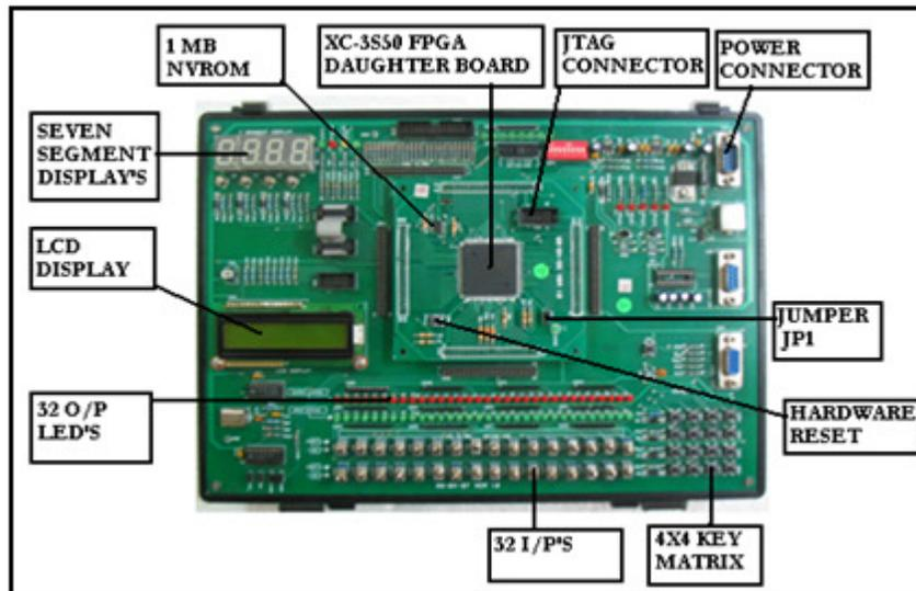
Fig.2 XC-3S50 FPGA VHDL TRAINER KIT
